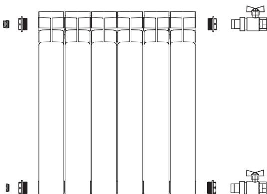
Комплектация радиатора RIFAR Base 500 для диагонального подключения к системе отопления.
