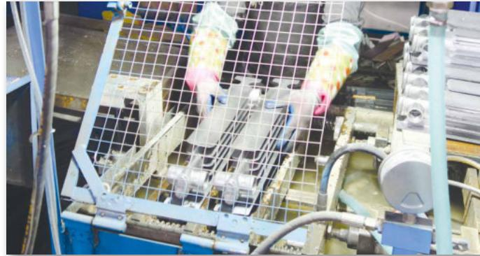
**Промежуточный контроль.** На соответствующем этапе производства, все секции радиатора проходят 100% проверку испытательным давлением 24 атм., что позволяет гарантировать надежную работу прибора при рабочем давлении 16 атм.
